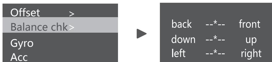
arrière--\*--avant : Si \* est vers l'arrière, la position de la caméra est en arrière et doit être ajustée vers l'avant ; si \* est vers l'avant, la position de la caméra est en avant et doit être ajustée vers l'arrière. Veuillez vous reporter à la page 6.
